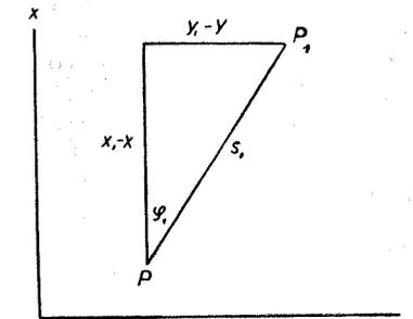
Beispiel 88. Die Lage eines Punktes  $P$  kann dadurch bestimmt werden, daß man von ihm aus die Richtungen zu  $n$  (mehr als 3) festen Punkten  $P_1, P_2, \dots, P_1 \dots P_n$  mißt. Bei den Ausgleichsrechnungen treten Ausdrücke von der Form  $a_i = \frac{\sin \varphi_i^0}{s_i^0} Q$
