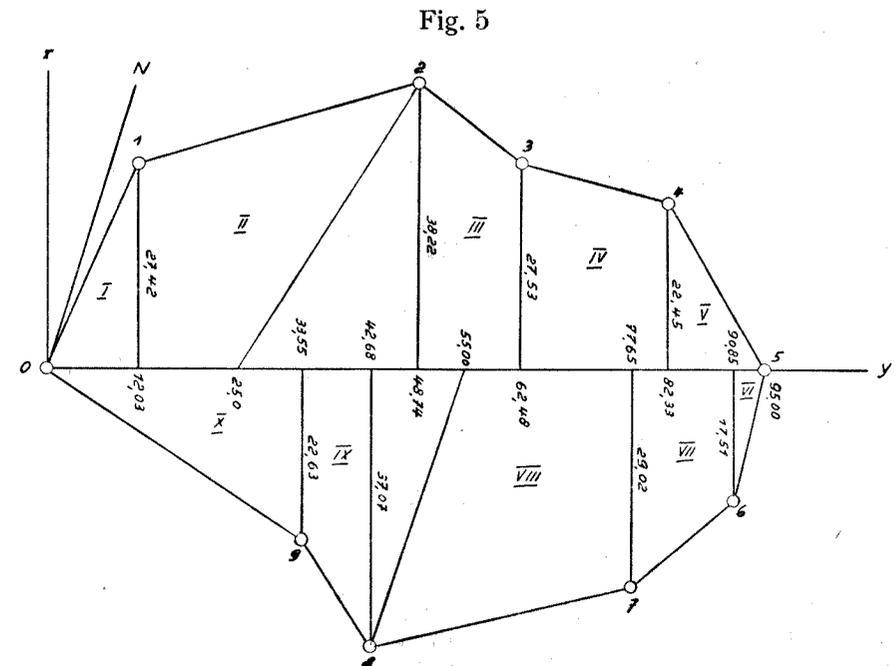
Lösung: Die zu messende Fläche ist in rechtwinklige Dreiecke und Trapeze zerlegt. Die doppelte Fläche eines rechtwinkligen Dreiecks ist gleich dem Produkt der Katheten. Die doppelte Fläche eines Trapezes erhält man, wenn man die Summe der parallelen Seiten mit der Höhe multipliziert. So ist hier  $2F_1 = 12,03 \cdot 27,42 =$
