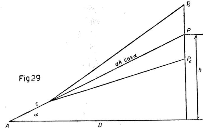
ermittelt werden und ist von der Größenordnung 0,5 m. Die große Konstante  $k$  ist gleich  $\frac{f}{p}$ . Der Fadenabstand  $p$  wird vom Mechaniker so gewählt, daß  $k \approx 100$  oder 200 ist. Da sich das nicht in aller Strenge durchführen läßt, so wird der genaue Wert von  $k$  durch Versuche bestimmt.
