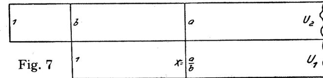
zweite Methode empfiehlt sich dann, wenn eine Anzahl von Brüchen mit gleichem Nenner  $b$  zu berechnen ist. Nach der Einstellung setzt man den Läuferstrich  $M$  einfach auf die verschiedenen Zähler  $a_1, a_2, a_3 \dots$  und liest unter ihnen sofort die Ergebnisse  $\frac{a_1}{b}, \frac{a_2}{b}, \frac{a_3}{b} \dots$  ab.
