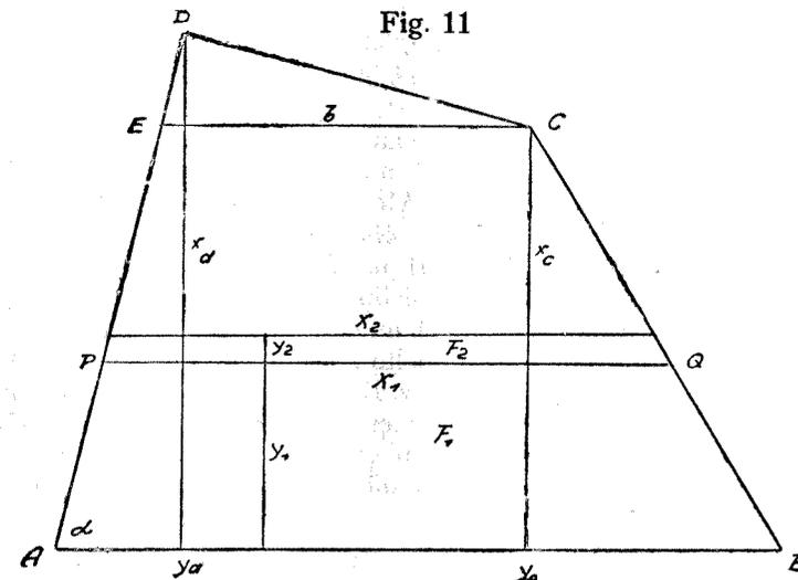
**Lösung (Fig. 11):** Der Abstand der Parallelen von A B,  $y$ , ist gesucht. Wäre die Fläche  $F$  ein Rechteck, so müßte seine Höhe,  $y_1$ , der Gleichung  $a \cdot y_1 = F$  genügen, es wäre also  $y_1 = \frac{8000}{174,55}$ ;  $\frac{80000}{69820} = 4 \dots$
