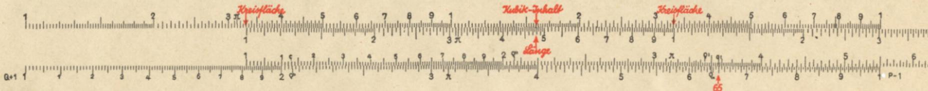
Bestimmung des Kubikinhalts: Kreisfläche aus dem Durchmesser, erstere multipliziert mit der Länge,  $\varnothing 0,65$ , Länge 4,80,  $\frac{65^2}{C_1} \times 4,80$  m
